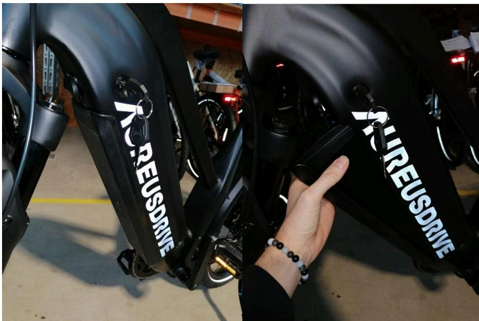
La batterie peut être retirée du vélo électrique. Pour ce faire, il faut tourner le guidon de manière à ce que le garde-boue ne soit plus sous le tube diagonal. Tournez la clé dans le sens inverse des aiguilles d'une montre et tirez simultanément le support vers le haut en haut. La batterie peut ensuite être retirée avec précaution par le bas - faites attention au poids.
